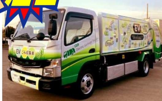
国内初の電気小型トラック『eCanter』によるEVごみ収集車が、神奈川県厚木市に昨年3月に納車され、同車両は厚木市環境センターにおいて排出された可燃ごみの焼却処理の熱を利用して、発電された電力で充電される仕組みとなっており、このEVごみ収集車は厚木市が目指す「循環型都市」を具現化するための注目の車両としての役割も担っています。
