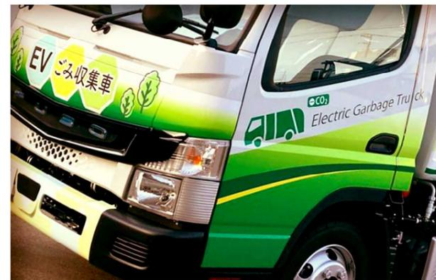
EVごみ収集車は、MFTBCと神奈川県厚木市、新明和工業の3者が2021年5月に締結した『EVごみ収集車』に関する連携協定\*に基づくものであり、走行時ゼロエミッションであるMFTBC「eCanter」を用いて、新明和工業による架装部分を含めた、ごみ収集(運搬)の際に出る二酸化炭素(CO2)を含む排気ガス等は一切排出されません。また、モーター駆動となることで騒音が少なくなり、住宅地での早朝からのごみ収集作業にも非常に適しています。
